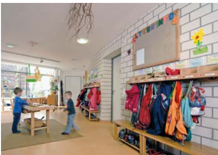
Bild 3 Innensichtmauerwerk aus KS-Verblendern
