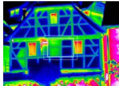
Nachweis von Wärmebrücken durch Thermografie-Aufnahmen
