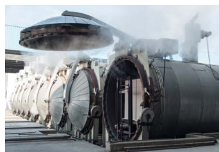
Die Rohlinge werden in Autoklaven gehärtet
