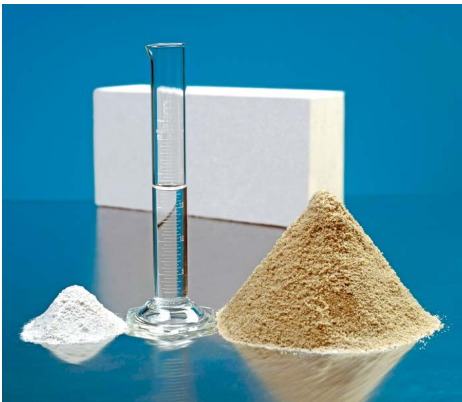
Ausgangsstoffe zur Herstellung von Kalksandsteinen: Kalk – Sand – Wasser – sonst nichts
